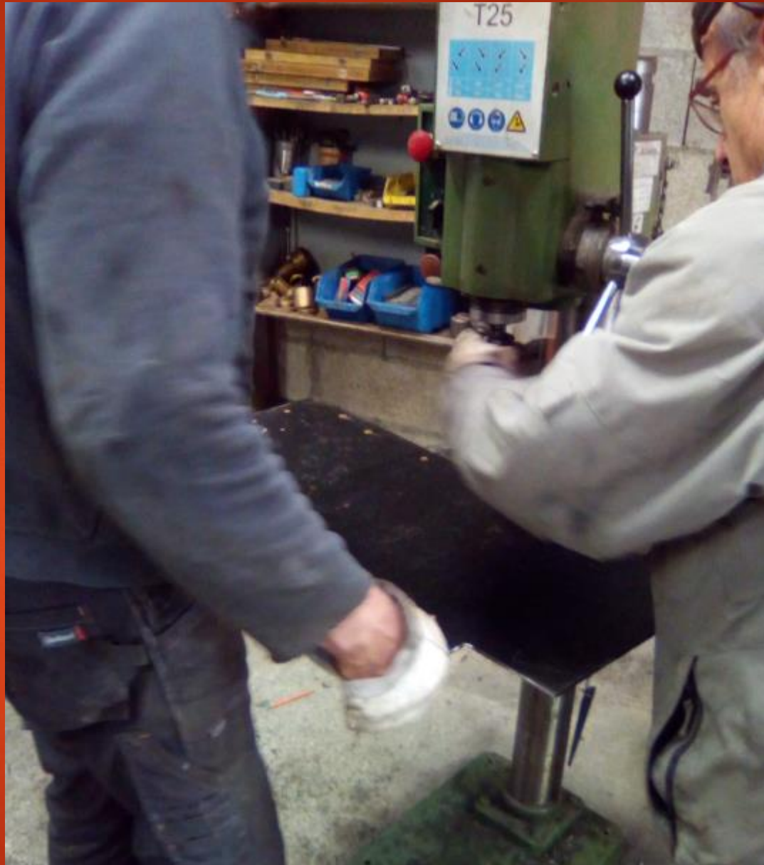
Découpe puis perçage d'un "nouveau" fond de caisse à charbon
